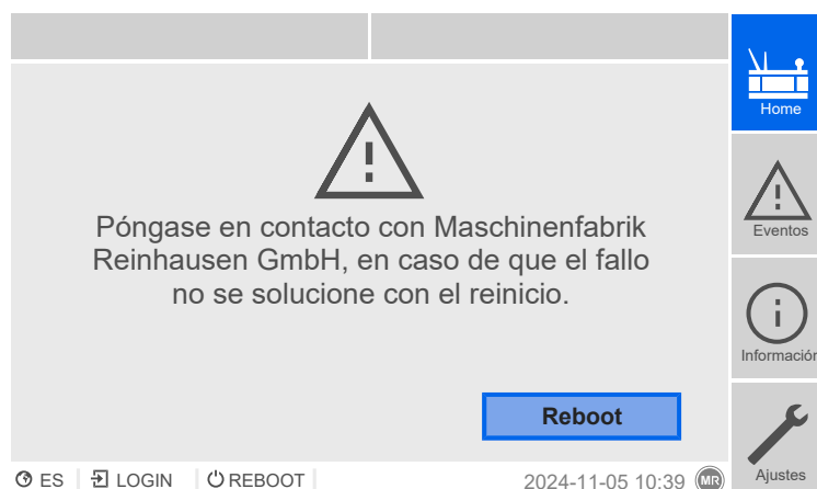
Figura 76: Señalización de fallo
