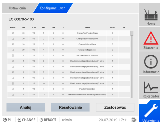
Rysunek 66: Konfiguracja punktów danych IEC 60870-5-103
