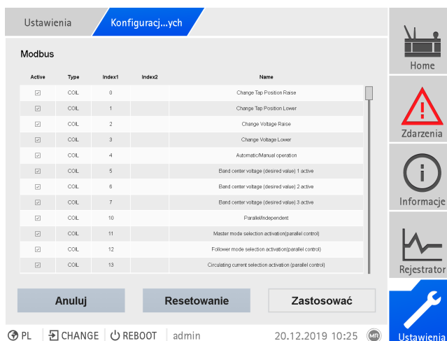
Rysunek 68: Konfiguracja punktów danych Modbus
