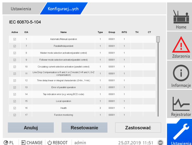
Rysunek 67: Konfiguracja punktów danych IEC 60870-5-104
