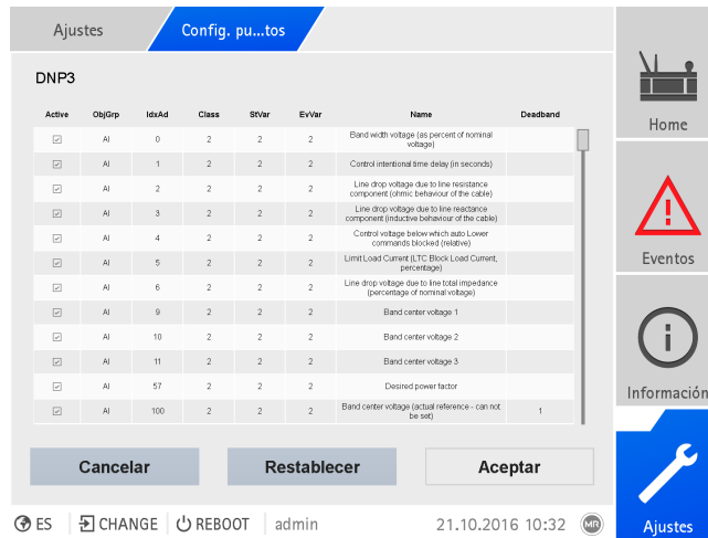
Figura 69: Configuración de puntos de datos DNP3
