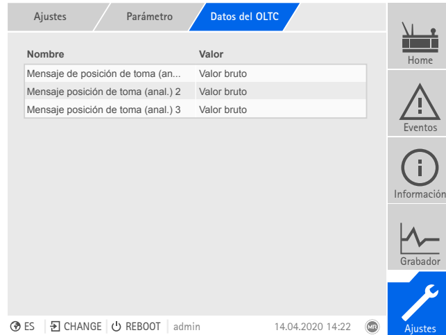
Figura 113: Datos OLTC (ejemplo con mensaje de posición de toma triple mediante salidas analógicas)
