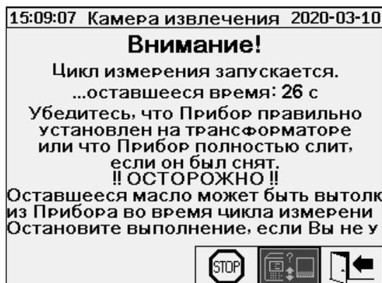
Время ожидания до автоматической активации. Это время отображается с помощью секундного таймера обратного отсчета. Кроме того, слышны короткие звуковые сигналы (первые 25 секунд - короткий звуковой сигнал каждые 5 секунд, а затем короткий звуковой сигнал звучит каждую секунду в течение последних 5 секунд).
