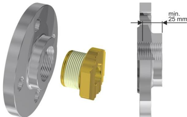
**Примечание:** Длина резьбы резьбового фланца или соединительного адаптера должна быть не менее 25 мм.
