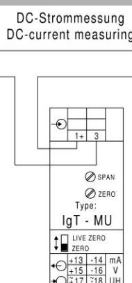
Bei Geräten mit Frequenzmodul entfallen weitere Ausgänge. An den Klemmen +13 und -14 steht der Frequenzausgang zur Verfügung.
