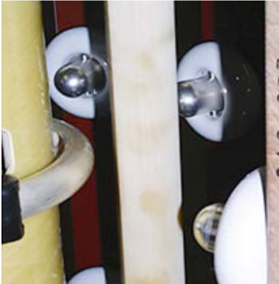
Abb. 4: Detail einer typischen Wähler-Kontaktanordnung
