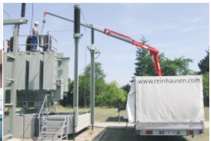
Rollende Werkstatt mit Kranwagen: Kran: Reichweite 13,60 m, Traglast bei max. Ausladung 320 kg
