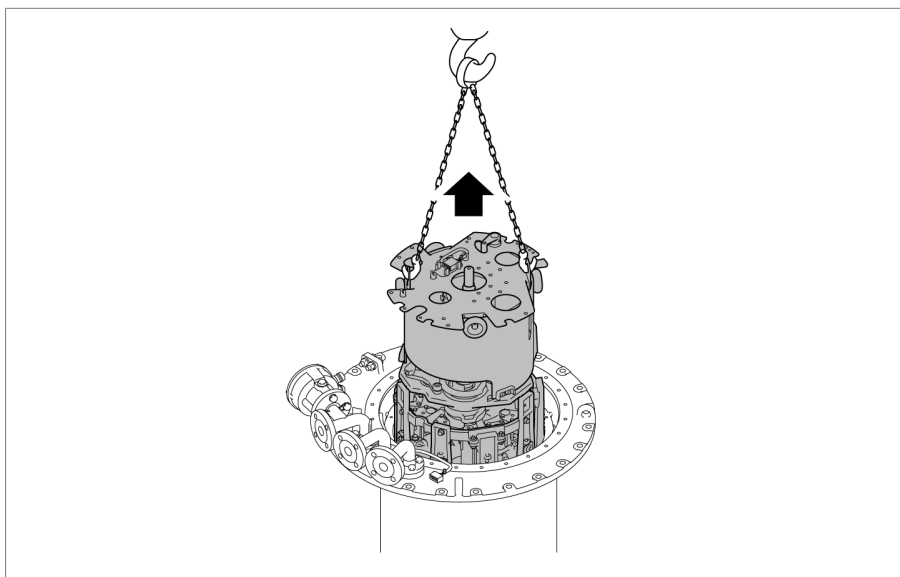
Figura 108: Extracción del cuerpo insertable del ruptor
